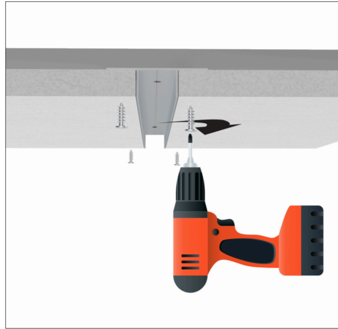
Una volta fissata la controcassa si procede con il fissaggio del pannello di cartongesso. L'installazione dovrà essere eseguita da personale qualificato
