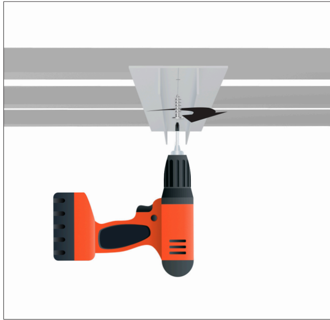
Fissare la controcassa Ghost 2 al montate del cartongesso
